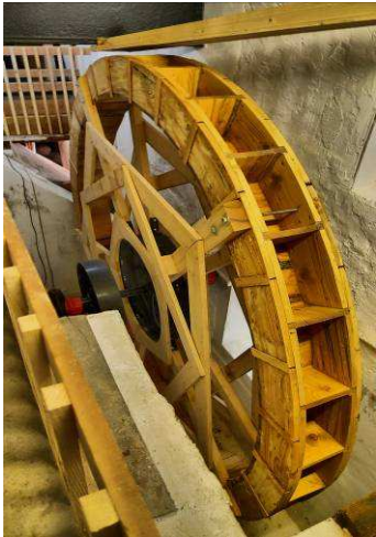
Roue à augets. En 1865, les moulins Rod en comptaient 4, et 5 paires de meules
